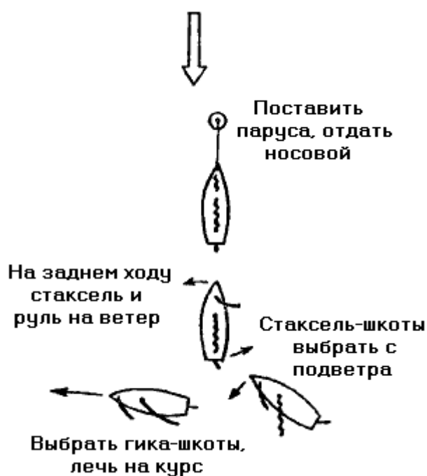
Рис. 123. Отход от бочки или причала на заднем ходу, когда за кормой есть место
