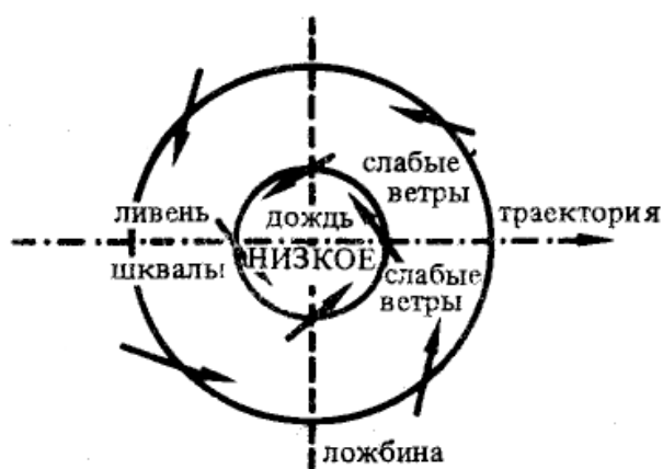
Рис. 54. Упрощенная схема депрессии, изобары расположены вокруг области низкого давления. Ложбина находится под прямым углом к траектории, ветер дует против часовой стрелки к центру циклона.
